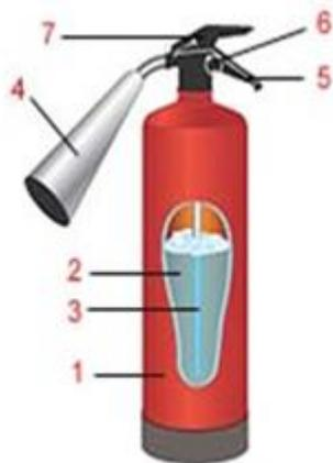
Рис. 8. Конструкция переносного углекислотного огнетушителя.
