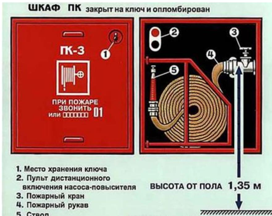
Рис. 13. Требования к размещению внутреннего пожарного крана.
